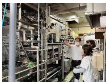
粉のミキシング機（麺の種類に応じて配合を変えています）→
